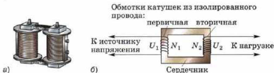
Рис. 134. Внешний вид и схема устройства повышающего трансформатора
