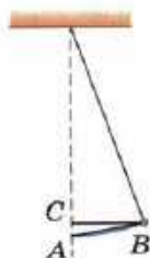
Рис. 59. При колебаниях с малой амплитудой длина дуги \widehat{AB} равна отрезку AB
