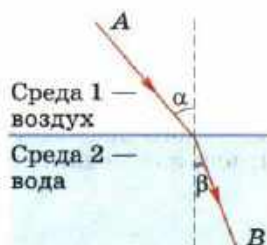
Рис. 141. Переходя из одной среды в другую, луч преломляется, т. е. меняет направление распространения
