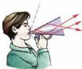
Рис. 82. Принцип действия рупора
