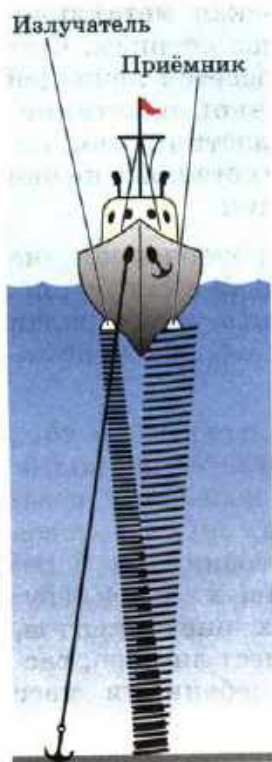
Рис. 78. Использование ультразвуковых колебаний для измерения глубины моря
