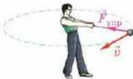
Рис. 41. Движение тела по окружности под действием силы упругости
