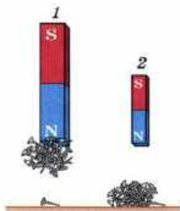
Рис. 111. Магнитное поле первого магнита сильнее, чем второго
