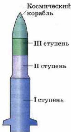
Рис. 49. Схема трёхступенчатой ракеты
