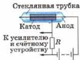
Рис. 159. Схема устройства счётчика Гейгера
