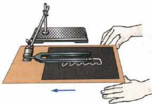
Рис. 77. Запись колебаний ветви камертона
