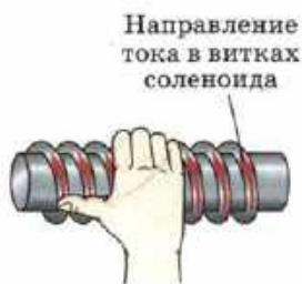
Рис. 97. Определение направления линий магнитного поля внутри соленоида
