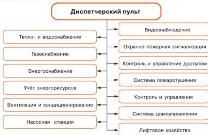
Рис. 4.4. Компьютеризированная система управления крупным коммунально-хозяйственным комплексом
