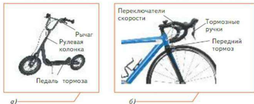
Рис. 4.1. Органы управления самокатом (а) и велосипедом (б)
