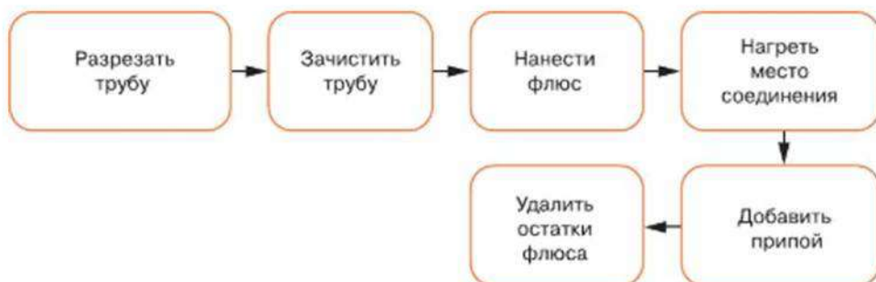
Рис. 5.5. Последовательность пайки
