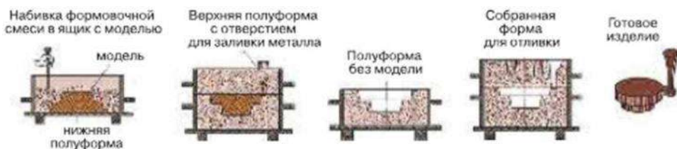
Рис. 5.3. Изготовление формы для отливки изделия
