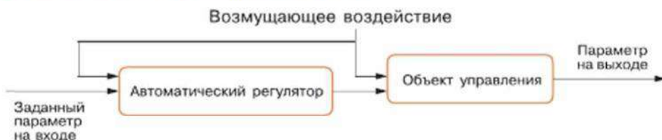
Рис. 4.5. Принцип управления по возмущению
